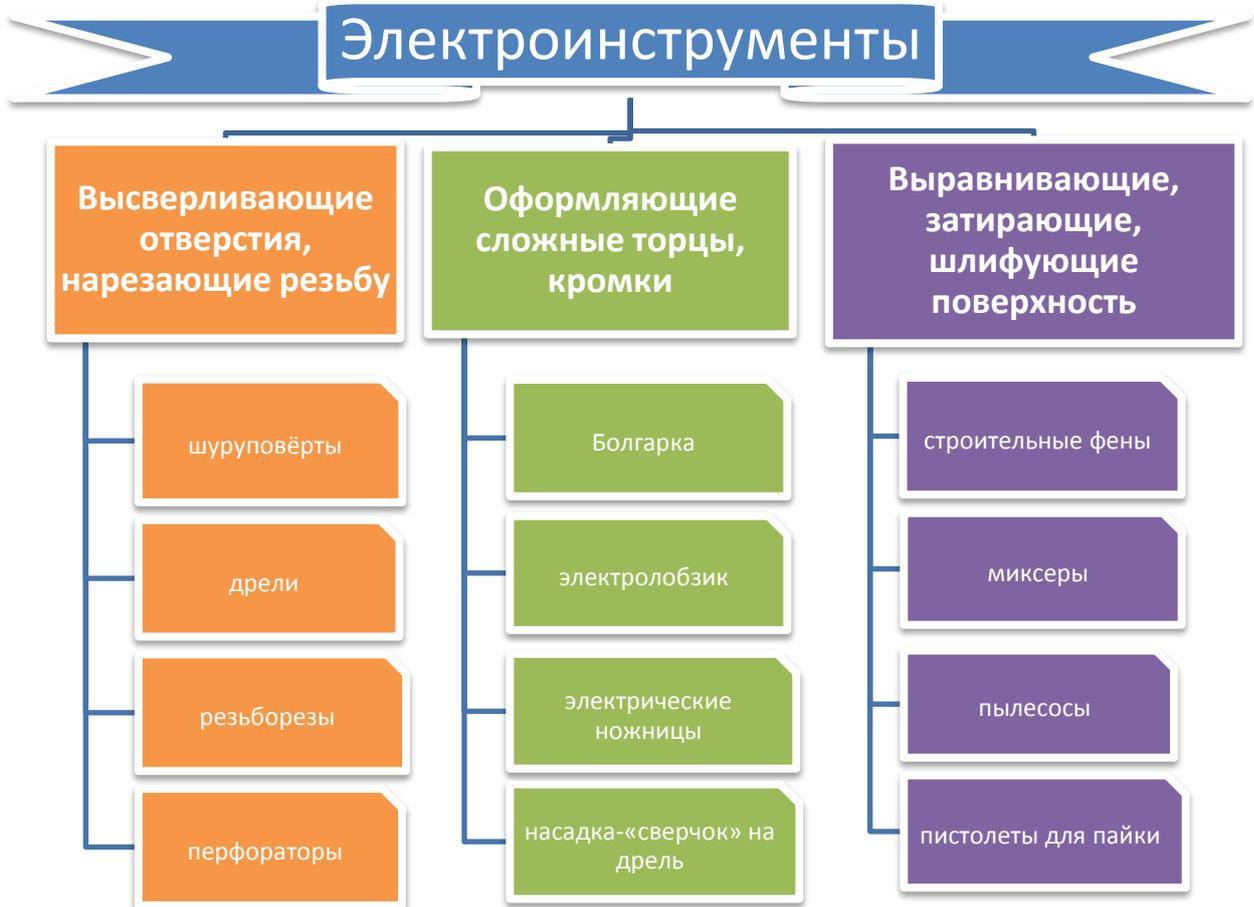
Рисунок 3 – Классификация электроинструментов по назначению
