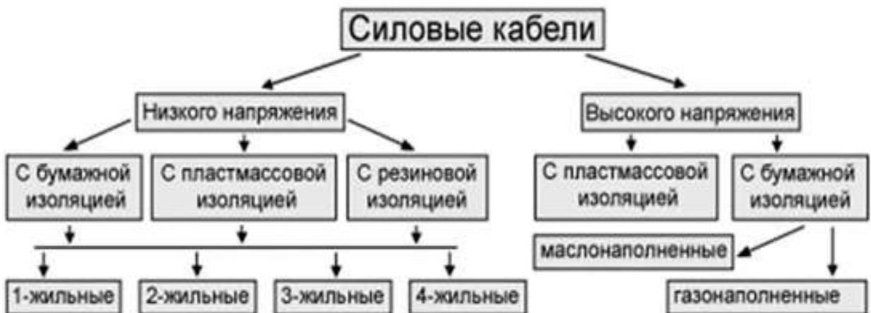
Рисунок 4 – Классификация силовых кабелей по напряжению
