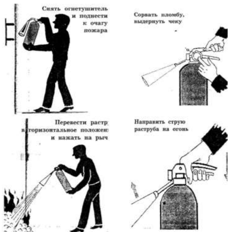
Рис. 3. Приведение в действие ручного углекислого огнетушителя.
