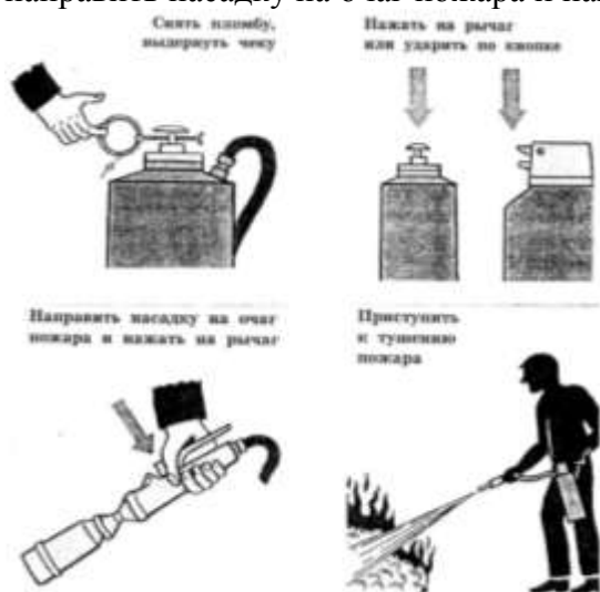
Рис.1. Приведение в действие воздушно-пенного огнетушителя.
