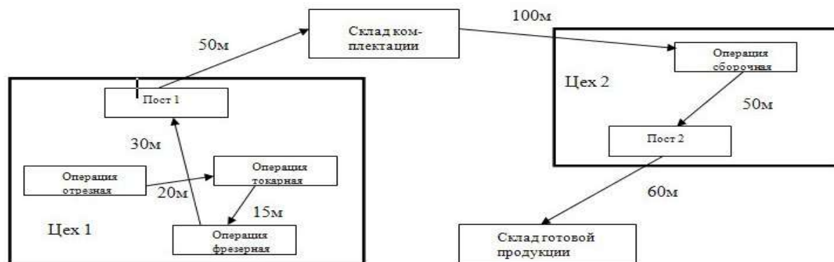
Рисунок 1 – Текущее состояние обработки детали в цехах №1 и №2
