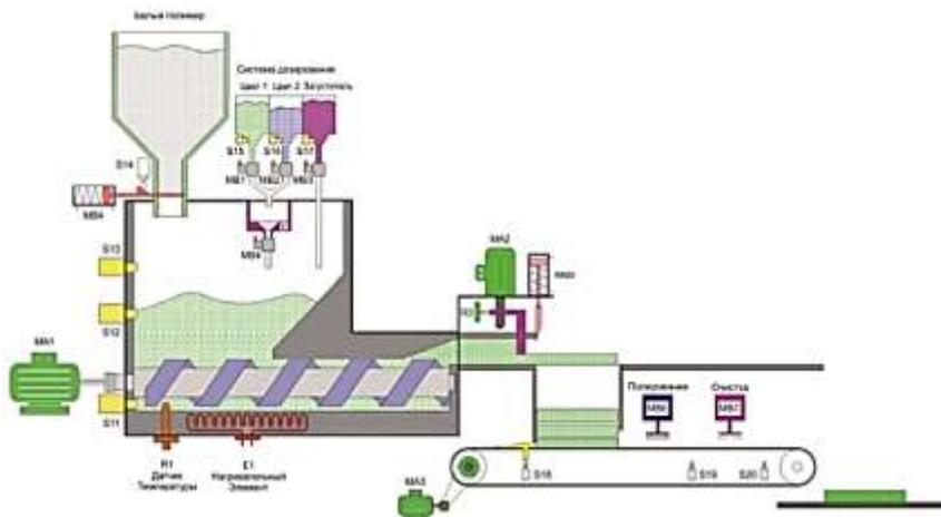
Рисунок 1 - Функциональная схема экструзионной машины
