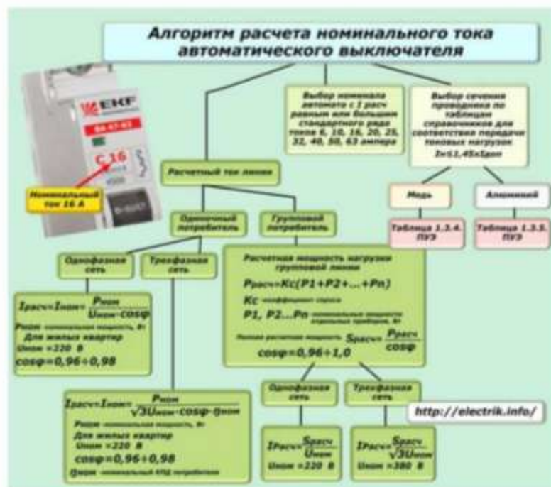
Рисунок 10 – Алгоритм расчета номинального тока автоматического выключателя
