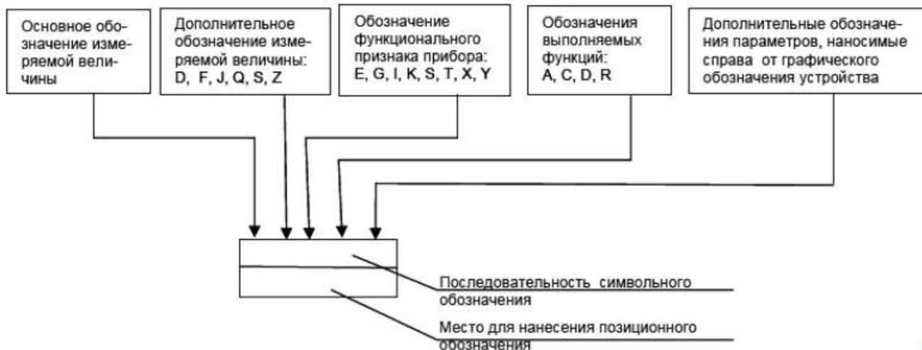
Рисунок 1 - Принцип построения условного обозначения прибора
