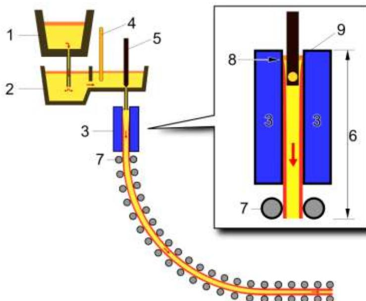
МНЛЗ включает в себя в том числе сталеразливочный 1 и промежуточный 2 ковши, водоохлаждаемый кристаллизатор 3, систему вторичного охлаждения, устройства для вытягивания заготовки из кристаллизатора, оборудования для резки и перемещения слитка.
