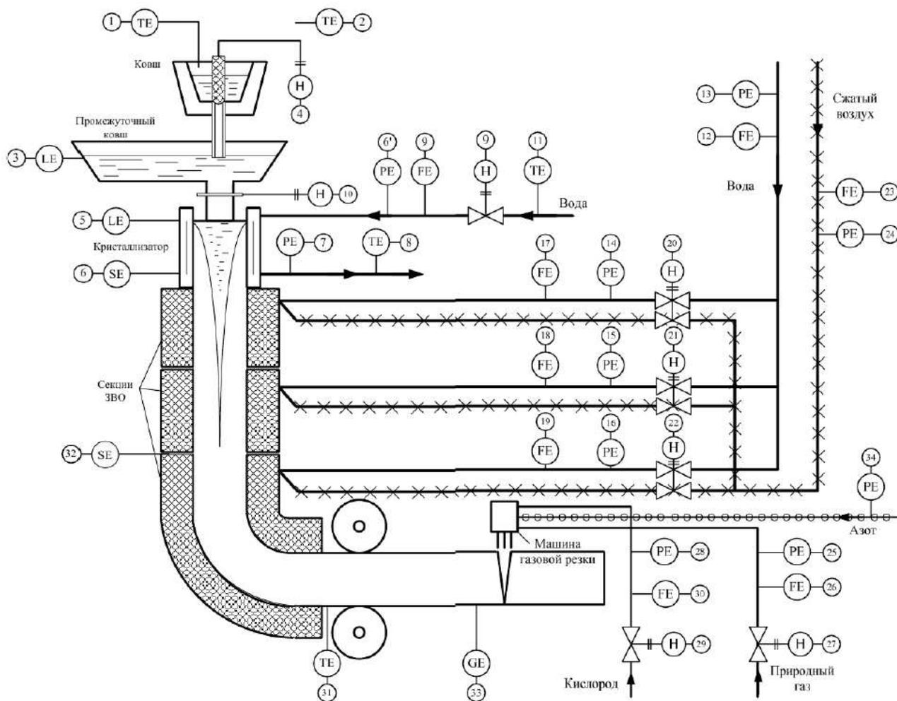
Схемой автоматизации теплового и технологического режима МНЛЗ предусмотрено :
