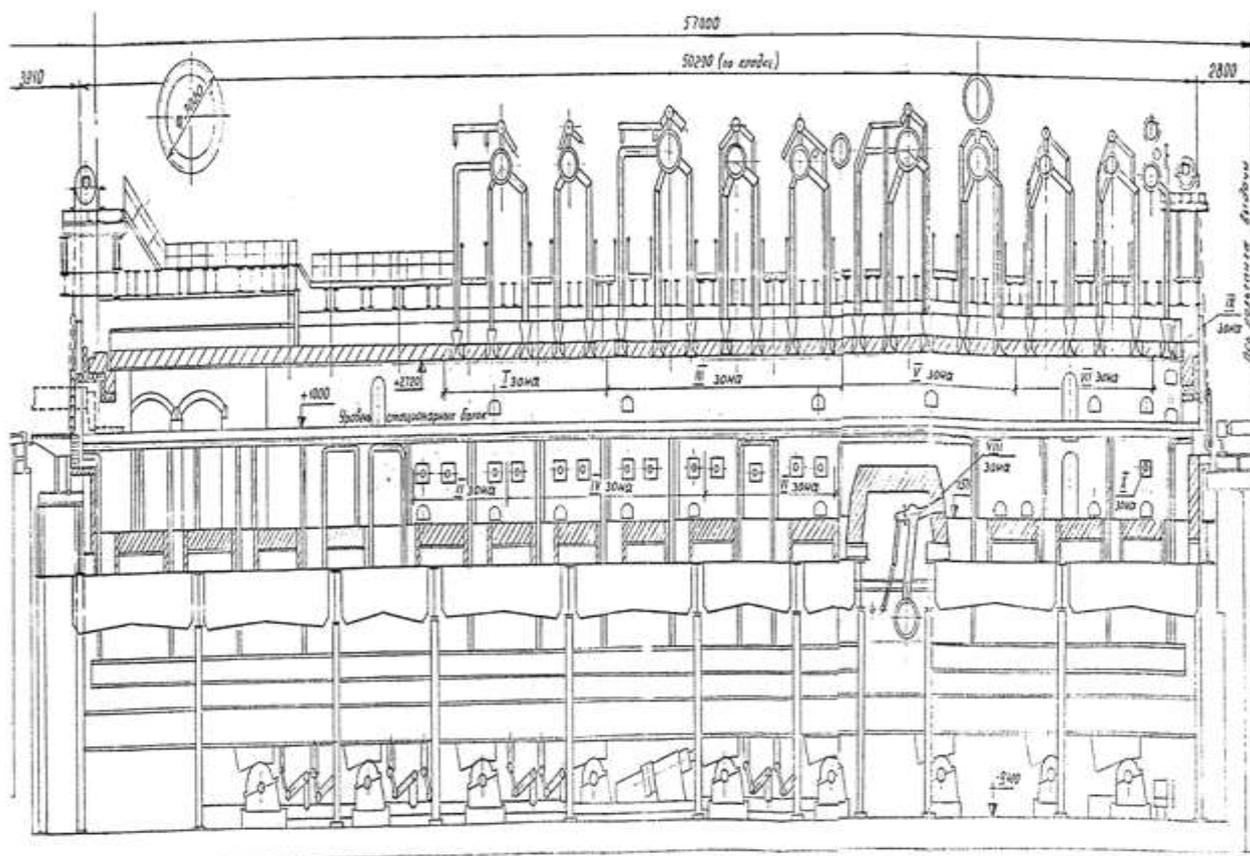
После того как слябы поступили в печь, они будут проходить поочередно все зоны печи. Рабочее пространство печи разбито на методическую зону (участок предварительного нагрева), сварочную зону (нагревательные зоны с высокой температурой, где происходит стремительный разогрев металла), томильную зону (зона выравнивания температур по сечению заготовки). Все зоны, кроме методической, оснащены горелками, в которых сжигается топливо. Топливом в печи является природный газ.
