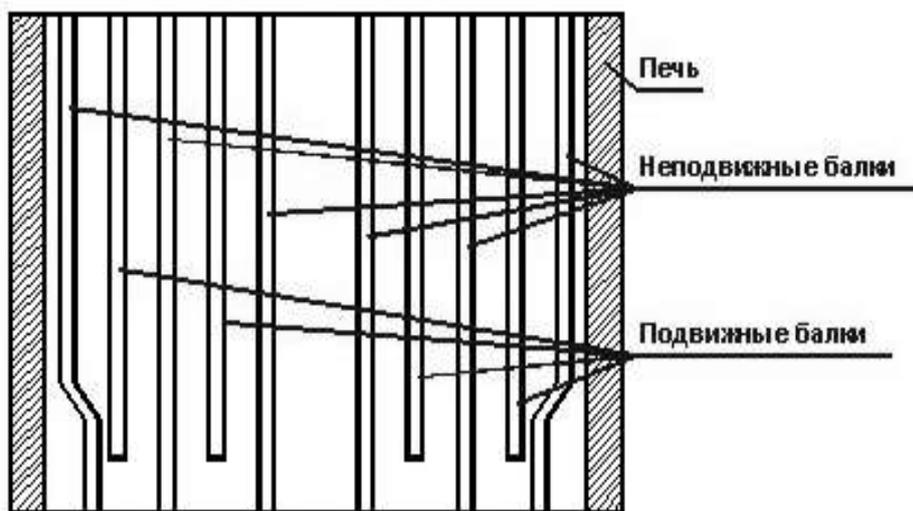
Методическая печь ШСГП 2000 ПАО «ММК» десятизонная и разделена на верхнюю и нижнюю части нагрева. При таком варианте нагрева сляб равномерно прогревается с двух сторон, что позволяет ему находиться минимально возможный промежуток времени в зоне нагрева и избежать образование окалин.
