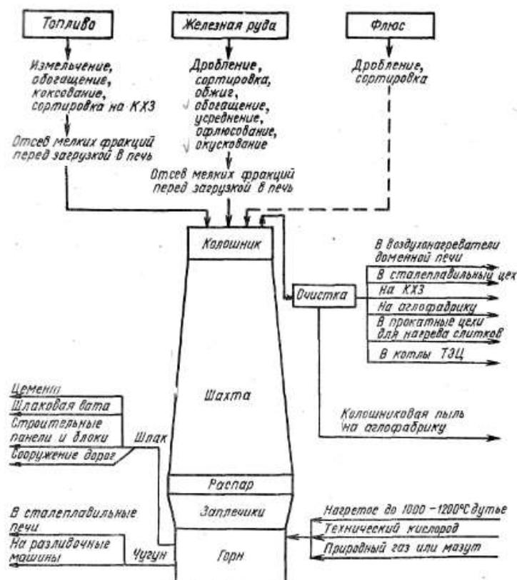
Для снижения расхода дорогостоящего кокса в качестве физического источника тепла используют горячее дутье. Температура нагрева воздуха колеблется 1150-1250 °С. Нагрев воздуха осуществляется в воздушнонагревателе (каупер).
