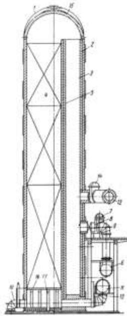
*Устройство воздухонагревателя: 1 - кожух; 2 - кладка; 3 - камера горения; 4 - насадка; 5 - разделительная стена; 6 - газовый клапан; 7 - отделительный клапан; 8 - подвод к горелке; 9 - горелка; 10 - дымовой клапан; 11 - клапан холодного дутья; 12 - патрубок трубопровода холодного дутья; 13 - трубопровод горячего дутья; 14 - клапан горячего дутья; 15 - футеровка купола; 16 - литые металлические поднасадочные решетки; 17 - литые металлические поднасадочные колонны*
