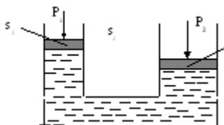
Принцип их работы основан на следующем: имеются два сообщающихся между собой цилиндра разного диаметра. Прилагая к поршню меньшего из цилиндров какую-то внешнюю силу  $P_1$ , мы тем
