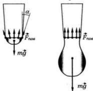
Сила поверхностного натяжения, действующая на небольшой участок границы длиной  $l$ , равна  $\sigma l$ , где  $\sigma$  – коэффициент поверхностного натяжения жидкости.
