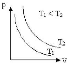
изображены две изотермы одной и той же массы газа. Чем отличаются состояние газов, если газы одинаковые? Чем отличаются газы, если температуры газов одинаковые? Указание: воспользуйтесь уравнением Клапейрона-Менделеева.
