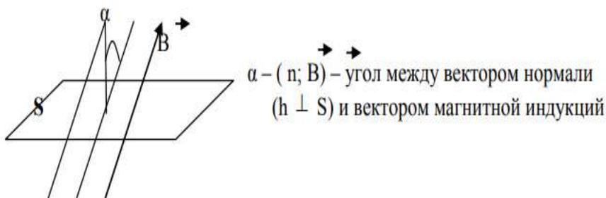
Величина силы, действующей со стороны магнитного поля на заряженную частицу, определяется по формуле Лоренца:  $F_l = B \times q \times v \times \sin \alpha$ , где  $q$  - заряд частиц,  $v$  - скорость движения частиц,  $B$  - магнитная индукция. Заряженные частицы движутся в однородном магнитном поле по окружности, радиусом  $R$ .
