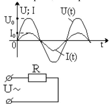
Включим резистор сопротивления  $R$  в сеть переменного тока напряжения  $U(t) = U_0 \sin \omega t$  (\*). В каждый конкретный момент времени прохождение переменного тока в резисторе качественно
