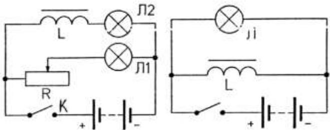
Рис. 4. Явление самоиндукции при размыкании цепи
