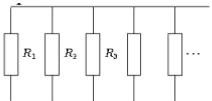
Для двух параллельно соединенных резисторов их общее сопротивление равно:
