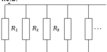
Для двух параллельно соединенных резисторов их общее сопротивление равно:
