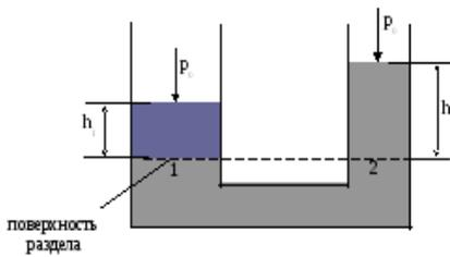
Рассмотрим сообщающиеся сосуды, заполненные несмешивающимися жидкостями с разной плотностью. Для каждой жидкости в отдельности справедливо уравнение  $p_2 = p_1 + \rho \cdot g \cdot h$ . Используем его для определения высот столбов  $h_1$  и  $h_2$ . Рассмотрим случай, когда на свободной поверхности жидкостей давления одинаковы и равны  $p_0$ . Так как все точки поверхности раздела принадлежат однородной жидкости, то эта поверхность является одновременно и поверхностью равного давления.
