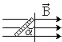
Переменный ток – вынужденные гармонические электромагнитные колебания в проводнике. Вследствие электромагнитной индукции в рамке возникает гармонически меняющаяся ЭДС  $\varepsilon = -\Phi' = B \cdot S \cdot \omega \cdot \sin\omega t$  или  $\varepsilon = \varepsilon_0 \cdot \sin\omega t$
