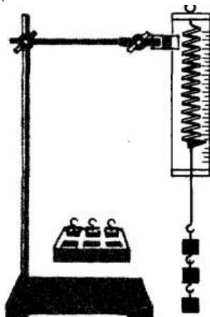
То есть с ростом деформации модуль (значение) силы упругости (в пределах упругих деформаций) растет прямо пропорционально. Коэффициент упругости из закона Гука легко найти, учитывая численное равенство (по III-му закону Ньютона) силы упругости и веса тела, натягивающего пружину (резину):
