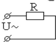
Включим резистор сопротивления  $R$  в сеть переменного тока напряжения  $U(t) = U_0 \sin\omega t$  (\*). В каждый конкретный момент времени прохождение переменного тока в резисторе качественно
