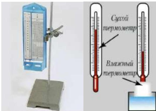
Рисунок 1. Установка для лабораторной работы №5
