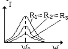
Электромагнитный резонанс (как и механический) наступает при совпадении частоты внешних воздействий с собственной частотой колебаний системы, при этом активное сопротивление действует аналогично силе трения – переводит энергию колебаний в энергию потерь (тепло).
