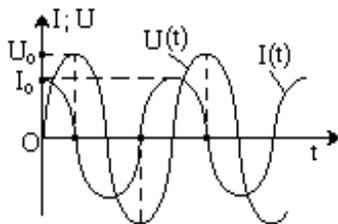
Известно, что конденсатор постоянный ток не проводит (цепь между обкладками разомкнута). Включим конденсатор емкости  $C$  в цепь переменного тока напряжения  $U(t) = U_0 \sin \omega t$  (\*).
