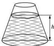
8. Какую силу давления испытывает стенка аквариума длиной 40 см, если угол ее наклона  $60^\circ$ , а высота воды в аквариуме 20 см (см. рисунок)? Атмосферное давление 105 Па.
