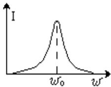
Соберем цепь из катушки тока  $A$  и источника переменного напряжения  $U = U_0 \cdot \sin \omega t$ . Активное сопротивление проводов и катушки индуктивности  $R \approx 0$ . Фиксируя  $U_0 = \text{const}$  и
