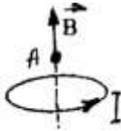
а) выбираем положение наблюдателя если смотреть на проводник сверху, то ток направлен против часовой стрелки. По направлению тока вращаем ручку буравчика, тогда сам буравчик будет двигаться вверх, следовательно, вектор магнитной индукции направлен снизу вверх;
