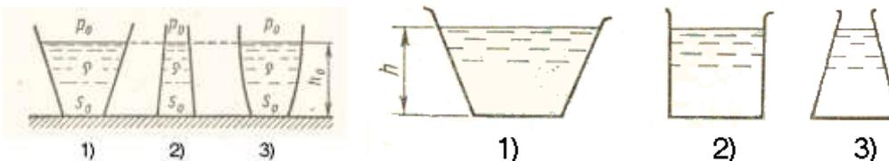
Так в расширяющихся кверху сосудах сила весового давления на дно меньше веса жидкости, в цилиндрических они одинаковы, а в суживающихся кверху – сила давления больше веса заключенной в сосуд жидкости.
