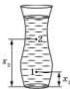
7. В сосуд, площадь поперечного сечения которого уменьшается в направлении от дна к верхней части, налита жидкость массой 1,6 кг (см. рисунок). Объем жидкости равен 2 л. Высота жидкости в сосуде равна 20 см. Найти давление жидкости на дно сосуда.  $h$
