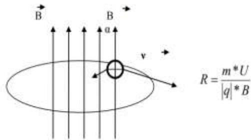
$R$  – радиус окружности [ $R$ ] = м,  $m$  – масса частиц, [ $m$ ] = кг,  $q$  - модуль заряда частицы, [ $q$ ] = Кл. Время, за которое частицы делают полный оборот (период обращения) равно:  $T = 2\pi R/v = 2\pi m/qB$ .
