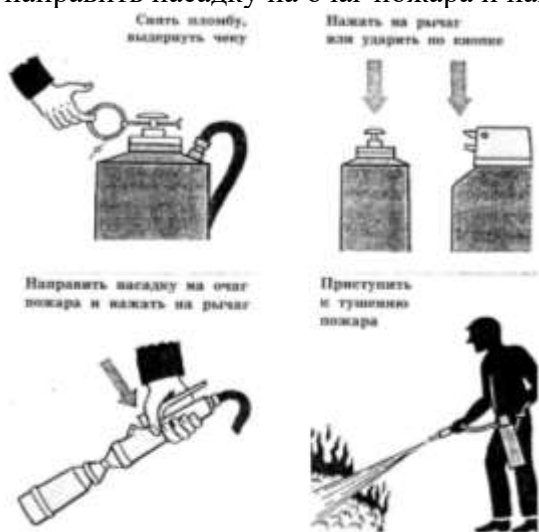
Рис.1. Приведение в действие воздушно-пенного огнетушителя.
