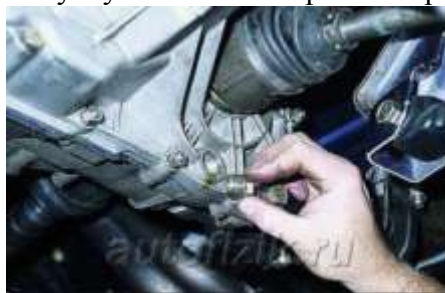
Рис. 2. проверка уровня масла в коробке передач
