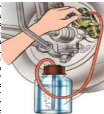
Рис. 2. Удаление воздуха из гидропривода тормозов: 1 - штуцер для прокачки; 2 - шланг; 3 - сосуд с жидкостью
