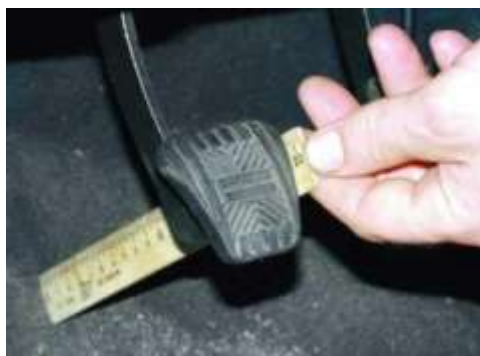
Рисунок 1- Проверка свободного хода педали сцепления
