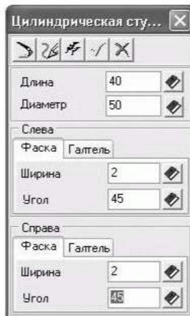
в котором кроме длины и диаметра ступени можно задать параметры различных конструктивных элементов на краях ступени (фаски или галтели). Установите длину и диаметр ступени равными 40 и 50 мм соответственно, слева ступени задайте фаску с катетом 2 мм и углом  $45^\circ$ , а справа – галтель наружу, радиусом также 2 мм. Нажмите кнопку ОК, чтобы построить ступень
