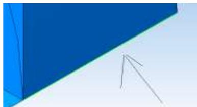
14. Создать поверхность выдавливания: нажать направляющий объект
