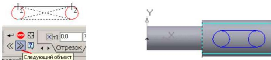
9. Для обрезки лишних дуг окружностей, выберите команду редактирования – Усечь кривую, укажите щелчком мыши на внутренние части окружностей, после чего они исчезнут. Получим следующий эскиз.
