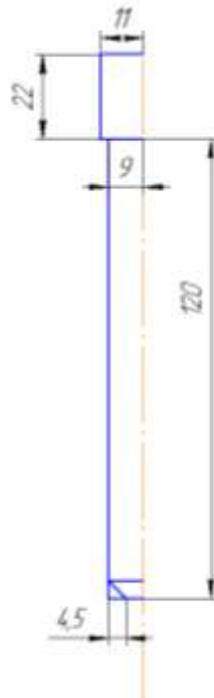
Для изображения резьбы выбираем тонкую линию, резьбу нельзя нарезать по основанию, поэтому выбираем отступ, окончание резьбы показывается сплошной основной линией.
