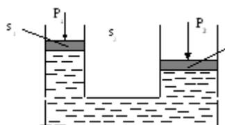
Принцип их работы основан на следующем: имеются два сообщающихся между собой цилиндра разного диаметра. Прилагая к поршню меньшего из цилиндров какую-то внешнюю силу  $P_1$ , мы тем самым создаем на
