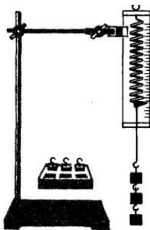
То есть с ростом деформации модуль (значение) силы упругости (в пределах упругих деформаций) растет прямо пропорционально. Коэффициент упругости из закона Гука легко найти, учитывая численное равенство (по III-му закону Ньютона) силы упругости и веса тела, растягивающего пружину (резину):
