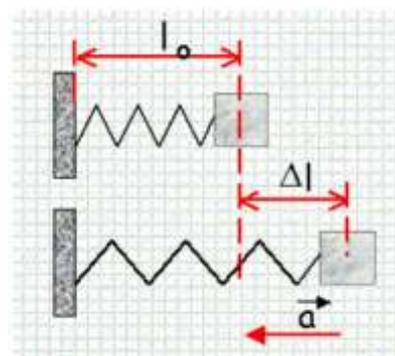
$\Delta l > 0$  деформация растяжения  $\Delta l < 0$  деформация сжатия
