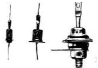
**Диод**- полупроводниковый прибор, предназначенный для усиления преобразования генерирования электрических колебаний различной частоты.
