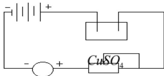
2. Составить электрическую цепь по схеме. При составлении цепи взвешенный электрод соединить с отрицательным полюсом источника электрической энергии.
