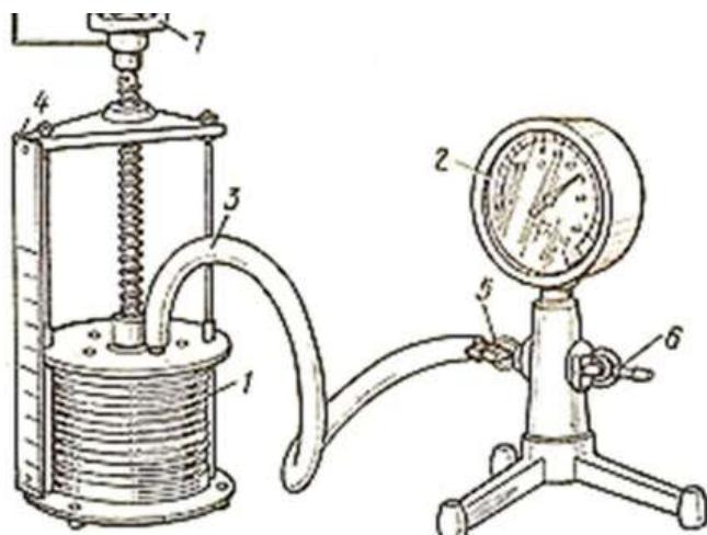
5. Закрыть внешний клапан манометра;
