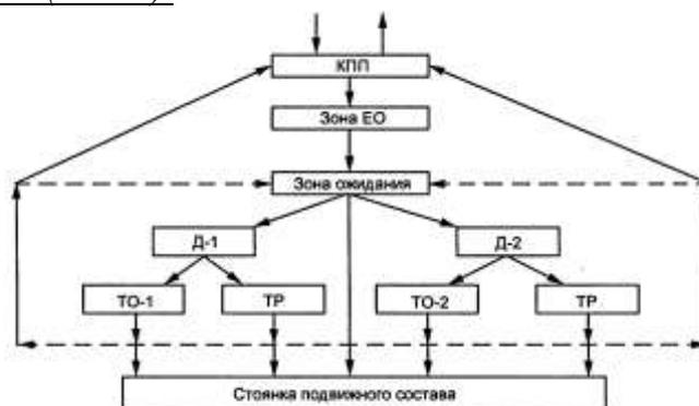
Рис. 4.1. Схема технологического процесса обслуживания автомобилей
