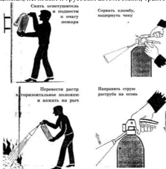
Рис. 3. Приведение в действие ручного углекислого огнетушителя.
