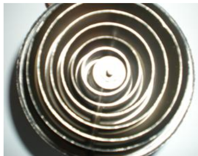
Рисунок 3.7 – Конструкция электроблока лабораторного электрофлотатора
