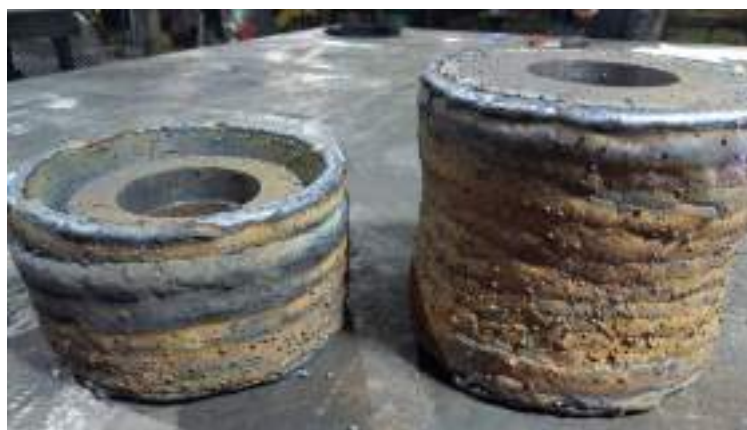
Рис. 2.63. Луппера с нанесенным защитным износостойким покрытием станов 170 и 370
