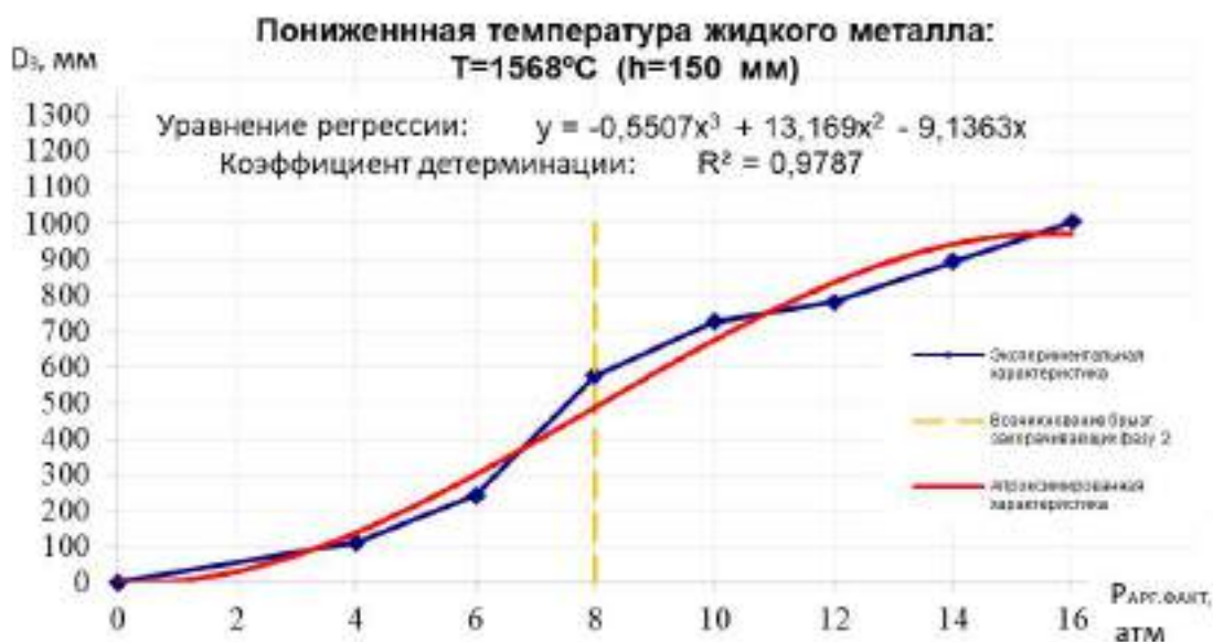
Рис. 1.20. Экспериментальная зависимость диаметра зеркала жидкого металла на УКП1 при донной продувке аргоном и температуре металла T = 1568^\circ\text{C}
