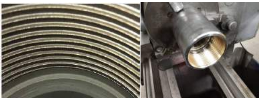
Рисунок 2.56. Внешний вид резьбовой поверхности муфт НКТ с двухслойным сухим твердосмазочным покрытием
