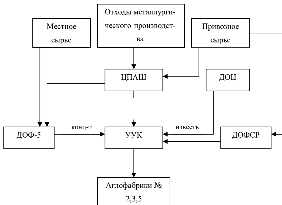
Рис. 3.10 Схема подготовки сырья к агломерации на ГОП ПАО «ММК»
