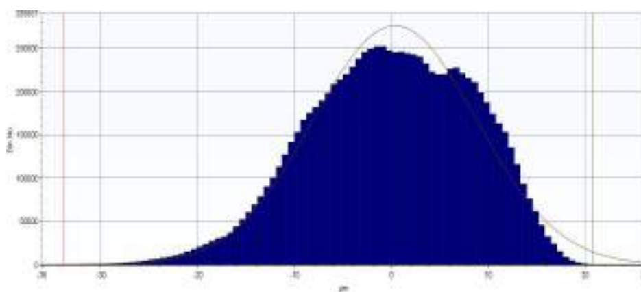
Рис. 2.41. Гистограмма распределения ординат поверхности ролика после токарной обработки
