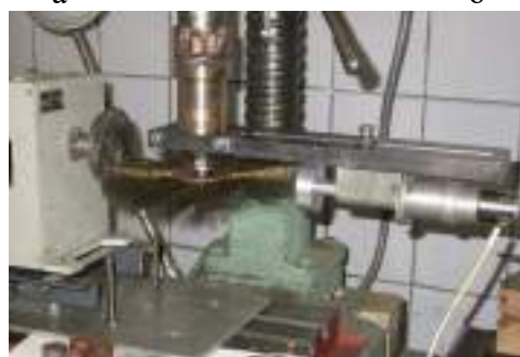
Рис. 2.48 – Нанесение покрытия методом электрофрикционного плакирования: а – подключение установки источника токовых импульсов; б – процесс нанесения покрытия; в – установка лабораторного исполнения
