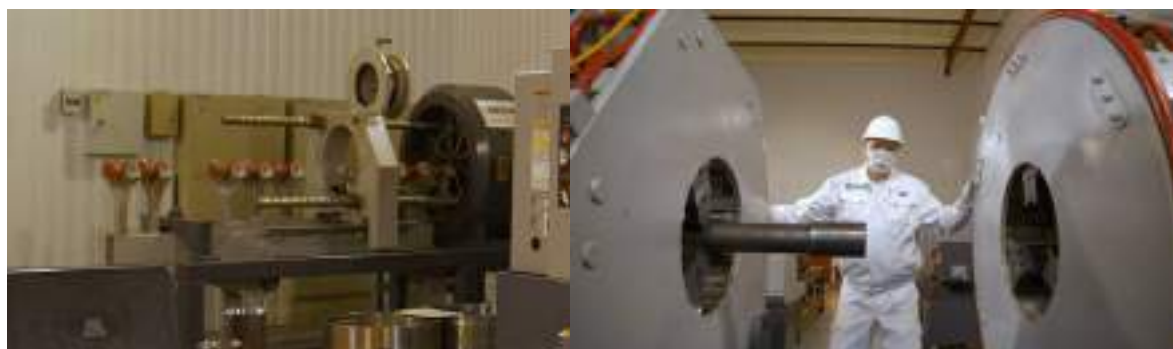
Рис. 2.54. Муфтонаверточная машина СКР-500 на экспериментальном участке резбовых соединений Premium АО «ПНТЗ».
