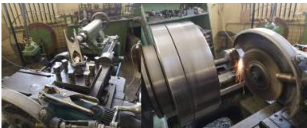
Рис. 2.25. Пример нанесения покрытия на роликовые образцы методом ЭФП: а – подключение установки источника токовых импульсов; б – процесс нанесе- ния покрытия
