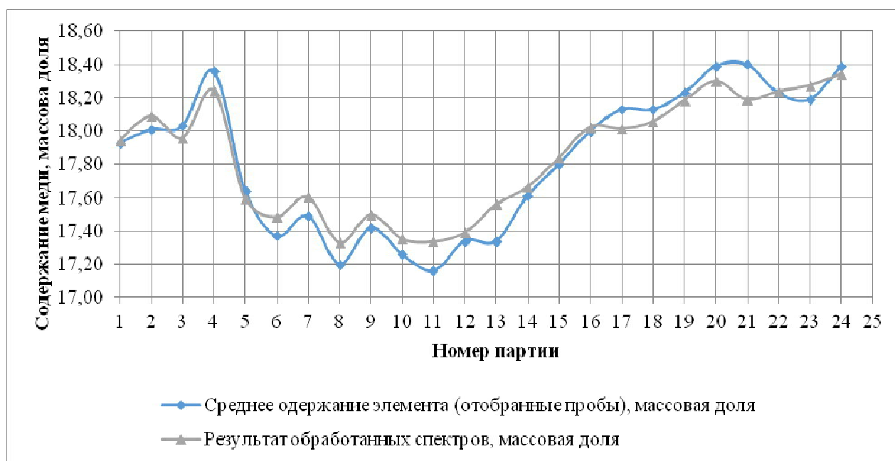
Рис. 3.6. Сравнение результатов химического состава партий по показаниям спектрометра CON-X 02 и результатам химического состава контрольных проб по содержанию меди.
