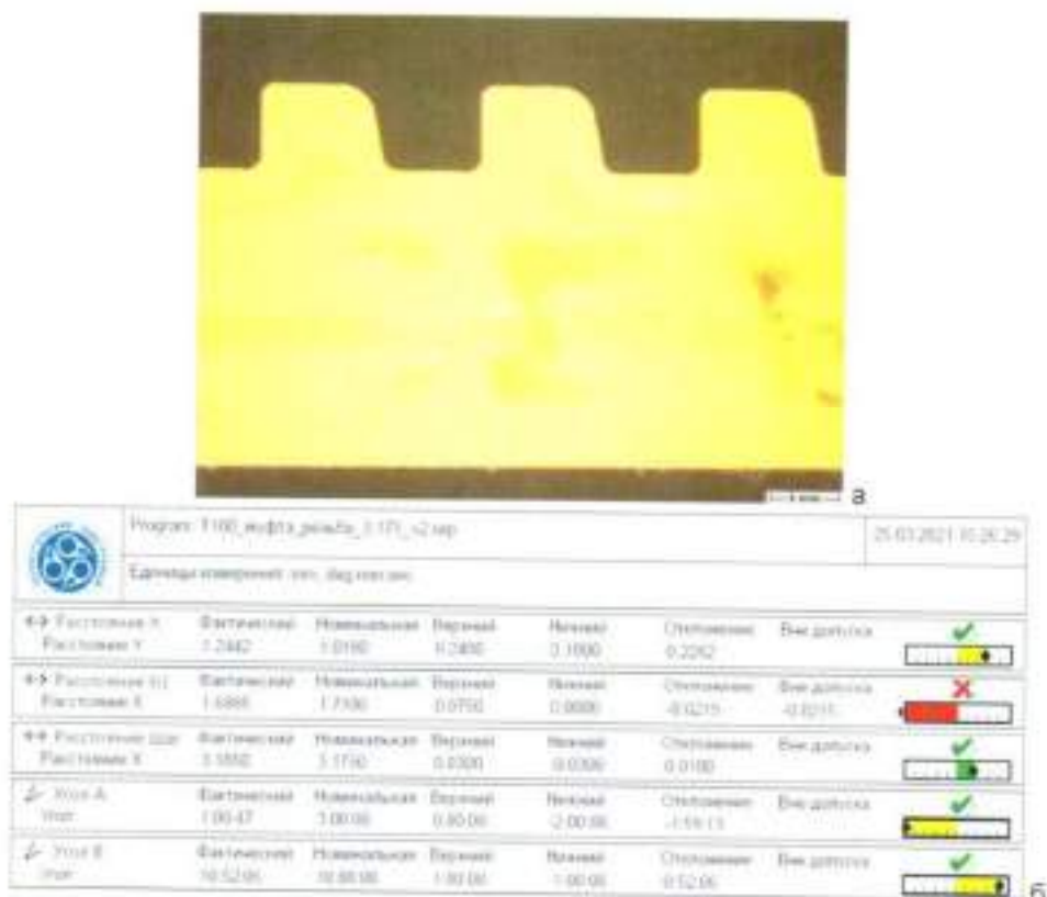
Рисунок 2 Профиль резьбы (а) и протокол контроля (б) профиля резьбы муфты
