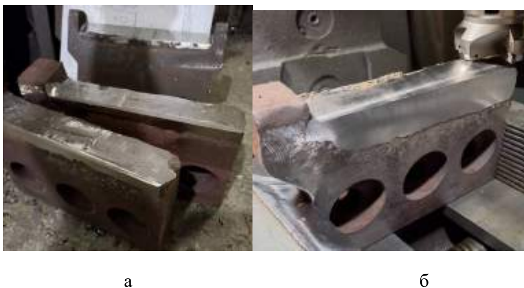
Рис. 2.60. Отрезные ножи горячей резки станов 170 и 370:
