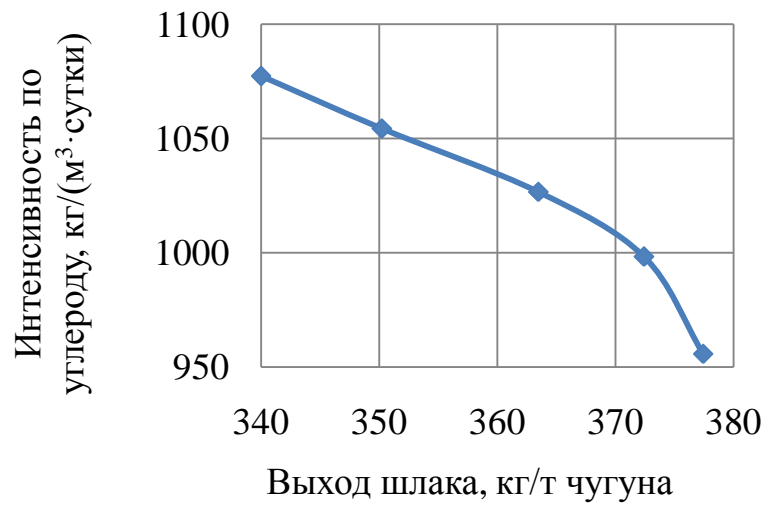
Рисунок 5.12 – Зависимость интенсивности по углероду от удельного выхода шлака
