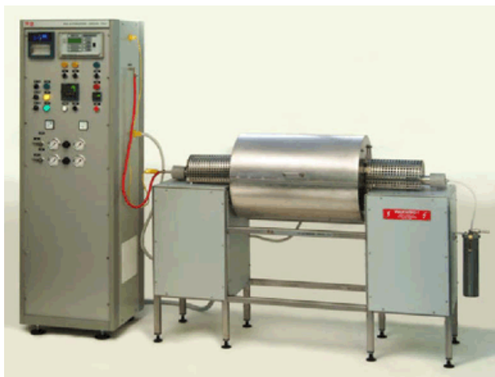
Рисунок 4.3 – Шкаф управления и горизонтальная печь для определения горячей прочности железорудных материалов по ISO 13930:2007
