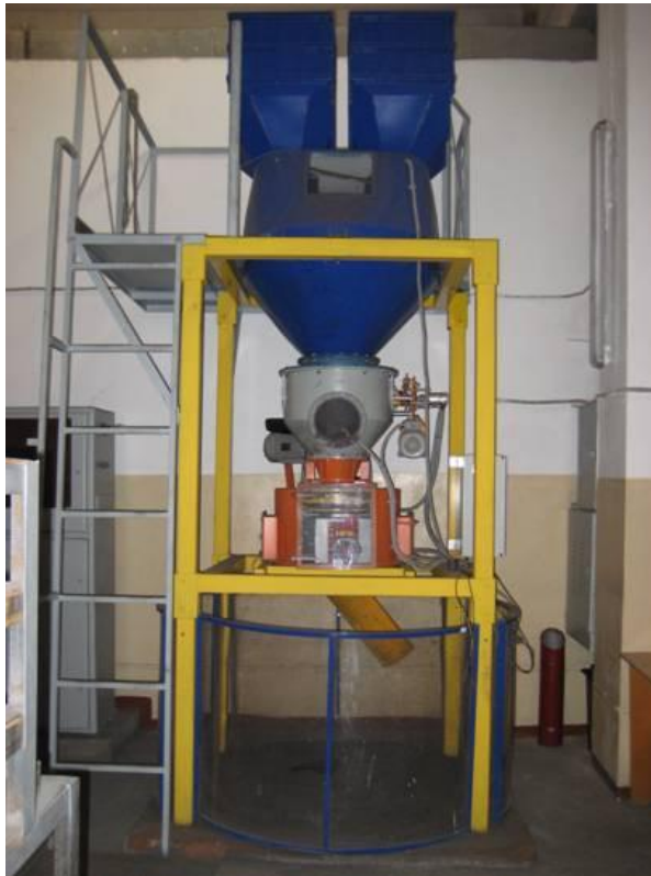
Рисунок 2.1 – Физическая модель однотрактового компактного загрузочного устройства лоткового типа
