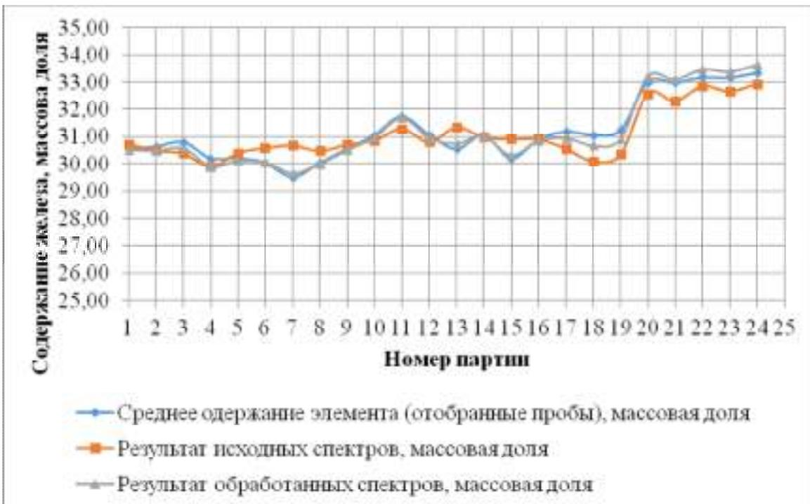
Рис. 3.36. Сравнение результатов химического состава партий по показаниям спектрометра CON-X 02 и результатам химического состава контрольных проб по содержанию железа.
