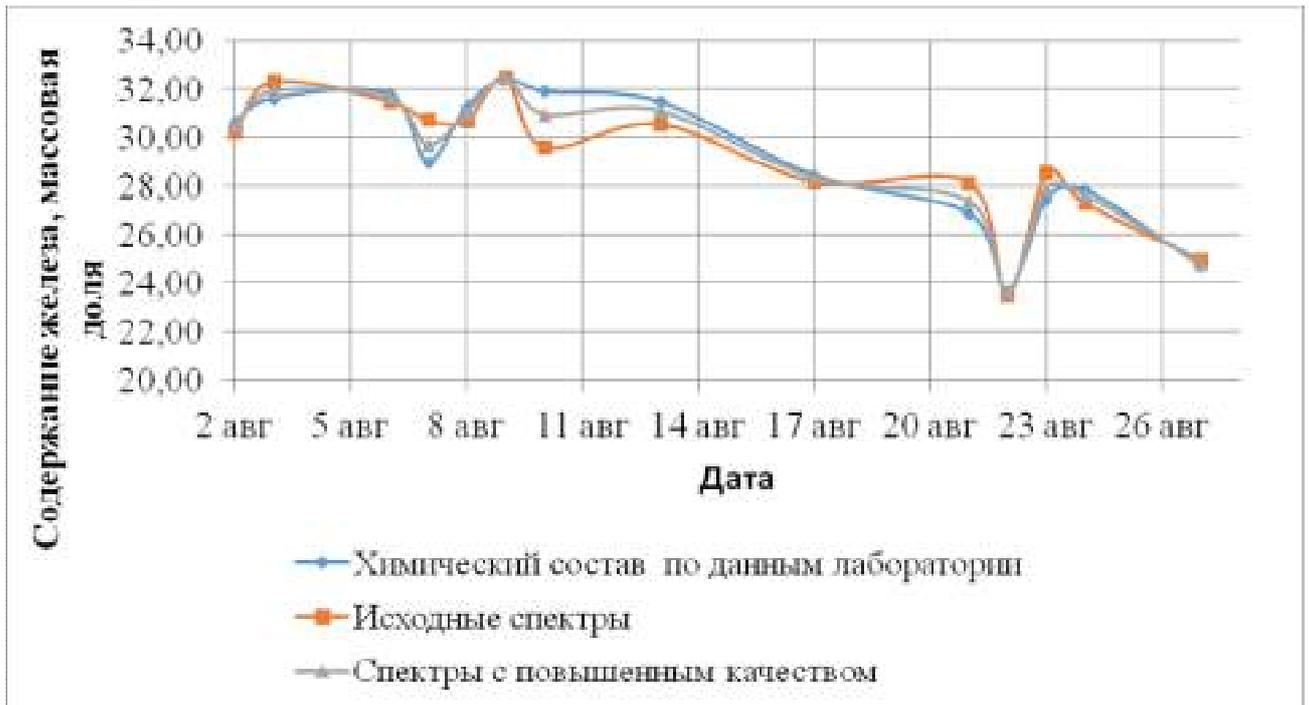
Рис. 3.25. Сравнение показаний спектрометра CON-X 02 и химического состава контрольных проб по содержанию железа
