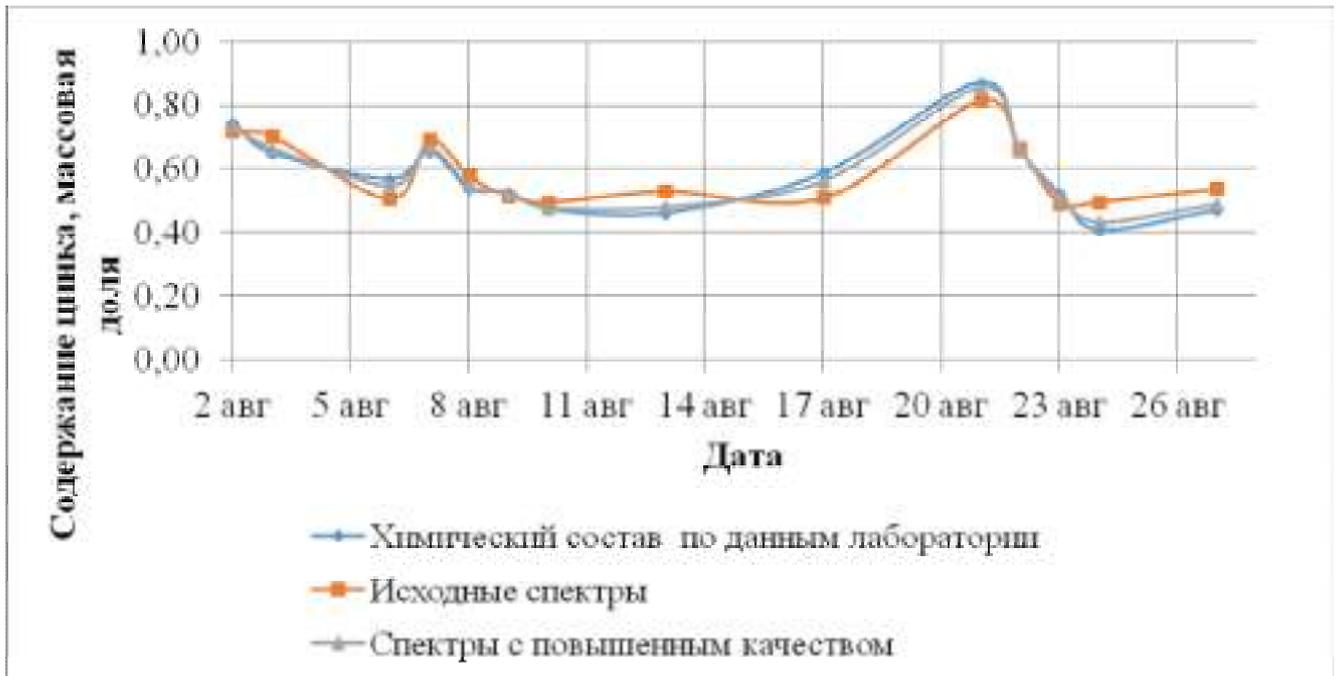
Рис. 3.27. Сравнение показаний спектрометра CON-X 02 и химического состава контрольных проб по содержанию цинка
