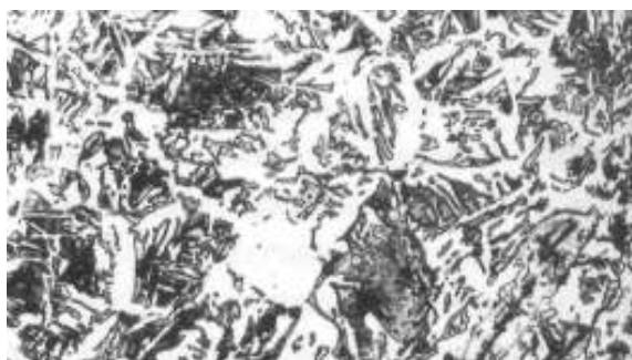
Рис.24. Структура перегрева в резьбовой части путевого шурупа из стали марки 20кп (видманштетт 3 балла)
