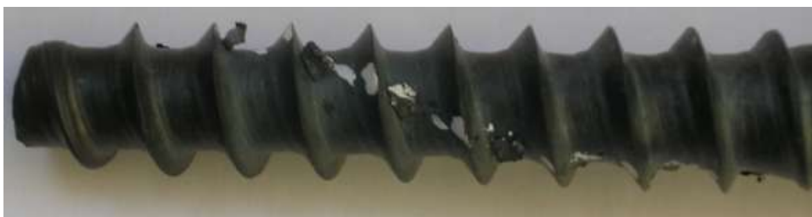
Рис.25. Резьба путевого шурупа, сформированная из заготовки с искусственной риской на проредуцированном участке
