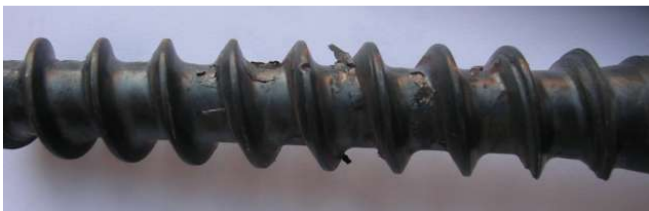
Рис.9. Дефекты резьбы путевых шурупов в виде задигов и отслоений
