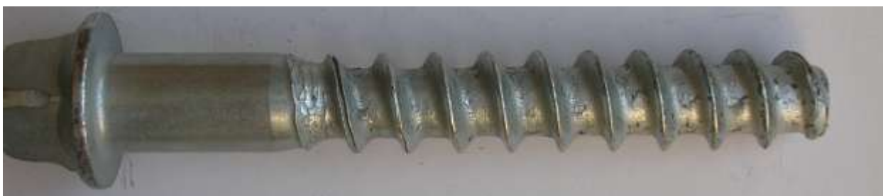
Рис.3.5. Путьевой шуруп 24x170 по ГОСТ 809-71, накатанный вхолдную на автомате-комбайне КА-84
