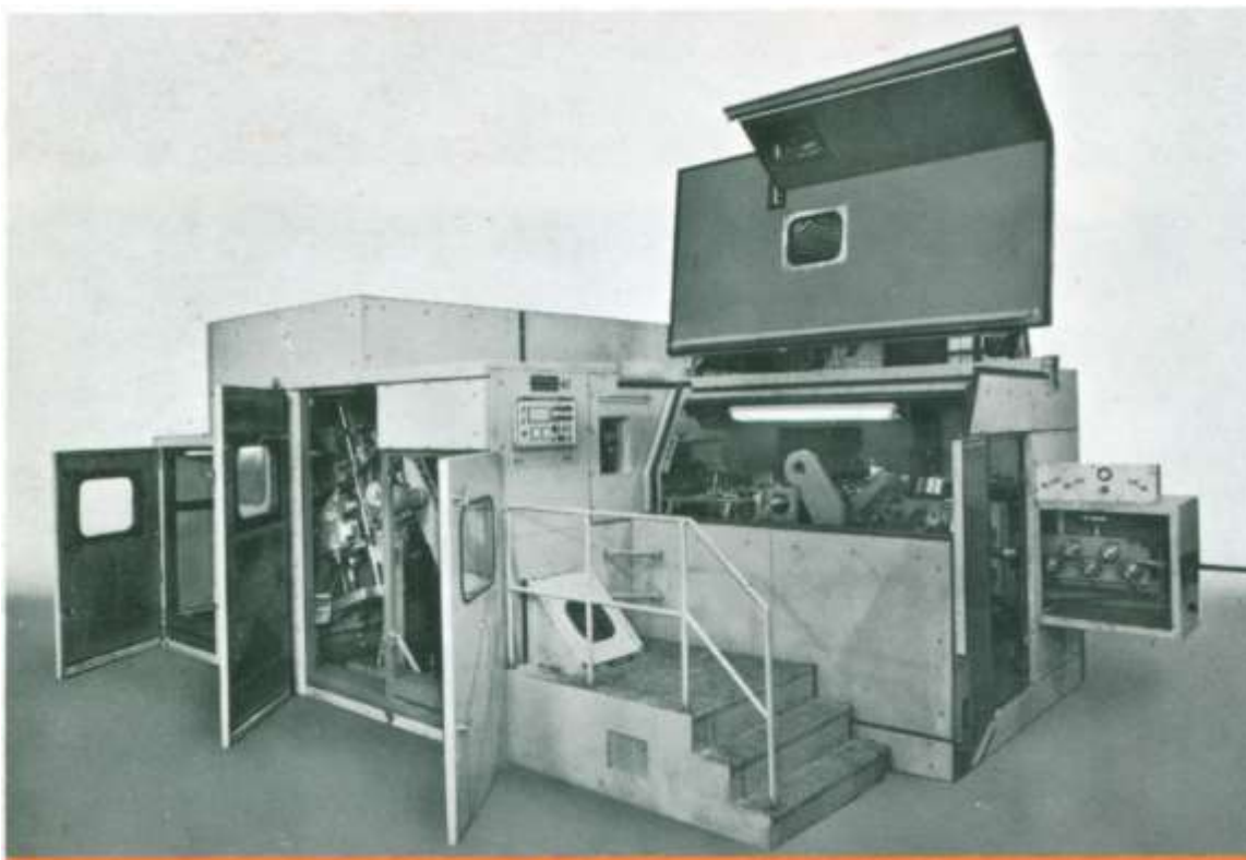
Рис.3.3 Автомат-комбайн КА-84 для изготовления стержневых крепежных изделий холодной штамповкой и накаткой резьбы плашками
