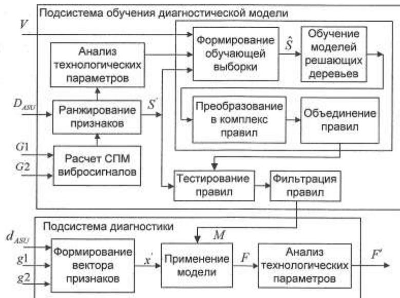
Рис. 2. Структурная схема системы диагностирования выбросов расплава
