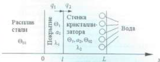
Рис. 1. Термодинамическая система "расплавленная металл—покрытие—стенка кристаллизатора"; \Theta_{01} ; \Theta_1 ; a_1 ; \lambda_1 ; \Theta_2 ; a_2 ; \Theta_{02} ; \lambda_2 ; l ; L — см. ниже по тексту
