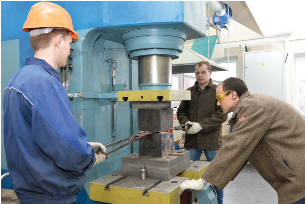
Процесс осадки полосы в лаборатории "Термодеформ"
