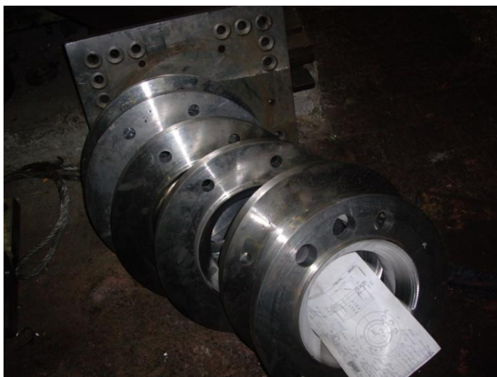
Опытная партия фланцев из патентованной марки стали для фурм доменной печи (ООО «Литейно-металлургические технологии»)
