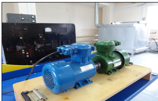
Взрывозащищенные асинхронные двигатели тип АИМЛ-71 (ООО «МГТУ – Энергосбережение+»)
