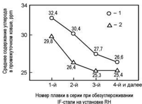
Рис. 2. Зависимость среднего за время разливки плавки содержания углерода в промежуточном ковше от номера плавки в серии при обезуглероживании IF-стали на установке вакуумирования:
