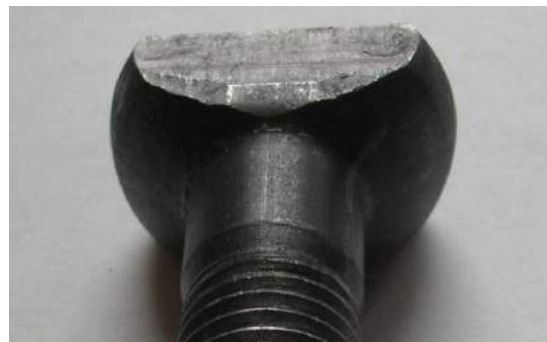
Рис.2. Головка клеммного болта, сформированная по старой технологии
