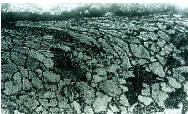
Рис. 4. Микроструктура приповерхностных слоев прутковой заготовки стали 40С2 после обточки [6]
