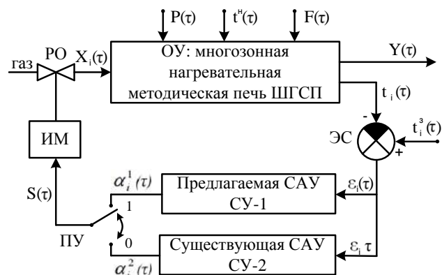
Рис. 1. Структурная схема достоверного определения удельного количества топлива при работе двух противопоставляемых систем автоматического управления тепловым режимом:
