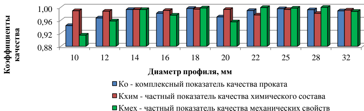
Рис. 2. Показатели качества отдельных профилей проката из стали марки 35ГС
