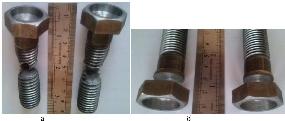
Рис. 2. Фотографии разрушившихся болтов: а – разрушение по резьбе ( h = 5,42 \div 6,48 мм); б – разрушение по головке ( h = 7,24 \div 7,32 мм)
