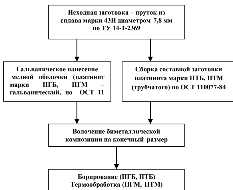
Рис. 1. Обобщенная блок-схема технологий производства платинита
