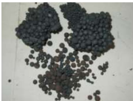
Рис. 2. Образец гибридного агломерата, полученный в лабораторных условиях
