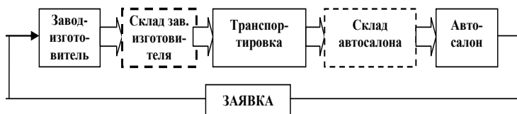
Рис. 3. Упрощенная схема доставки автомобилей
