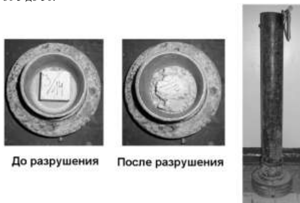
Рис. 1. Схема проведения испытаний бетонных блоков
