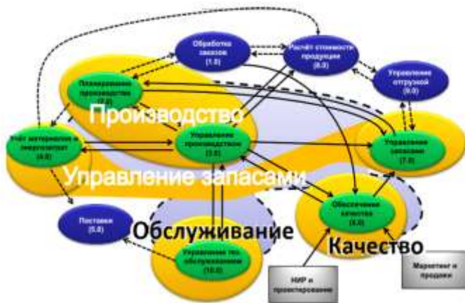
Рис. 2. Функциональная корпоративная модель ISA-95
