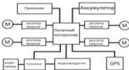
Рис.1 - Блок схема устройства БПЛА с 4 винтомоторными группами
