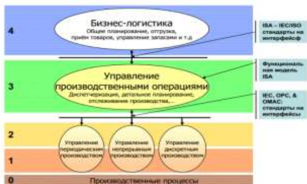
Рис. 1. Иерархическая функциональная модель ISA-95
