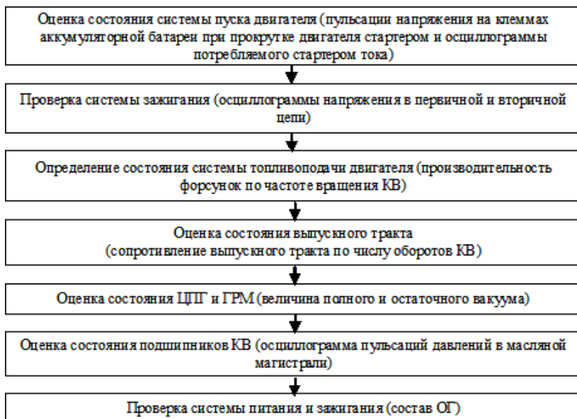
Рис. 1. Схема методики комплексного диагностирования двигателей с искровым зажиганием
