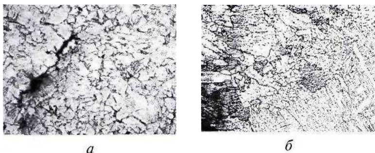
Рис. 2. Макроструктура в зоне зарождения трещины при сварке перлитными (а) и аустенитными (б) материалами (x1000)
