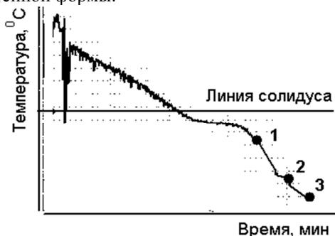
Рисунок 1. Зависимости температуры внутренней поверхности рабочего слоя листового вала от времени:
