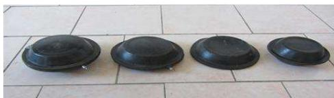
Рисунок 2. Линзообразные пневмодемферы для гашения колебаний
