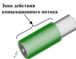
Рисунок 1. Модель ролика с заданным конвекционным потоком по поверхности с температурой 600, 700, 800, 1000, 1300<sup>0</sup> С и начальной температурой окружающей среды  $T_0=20^0$  С и температурой во внутреннем диаметре ролика  $T_v=60^0$  С
