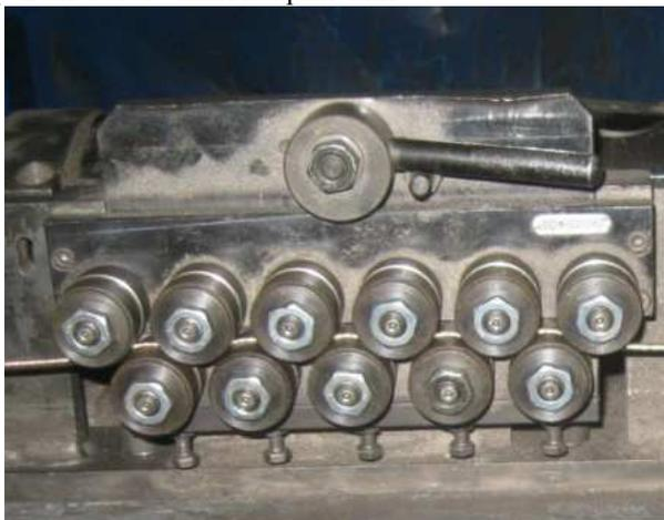
Рисунок 1. Общий вид роликовой рихтовки
