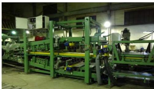
Рисунок 3 Непрерывная линия для производства сэндвич – панелей
