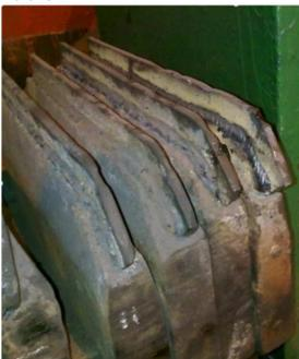
Рисунок 2. Внешний вид наплавленных проволок шаропрокатного стана
