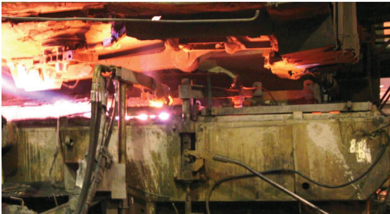
Рисунок 1. Испытания плазменного подогрева в промковше
