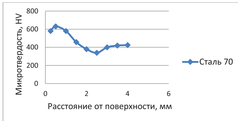
Рисунок 2. Распределение микротвердости по глубине закаленного слоя на рельсовой стали 70 с объемной закалкой и отпуском.
