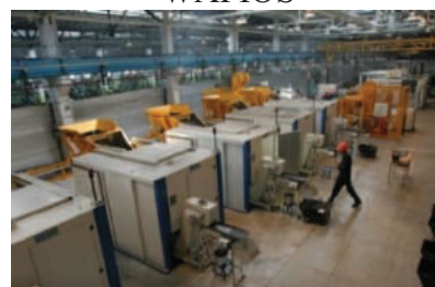
Рисунок 6. Резьбонакатные станки FN 6-60, FN 6/8-80 фирмы HILGELAND
