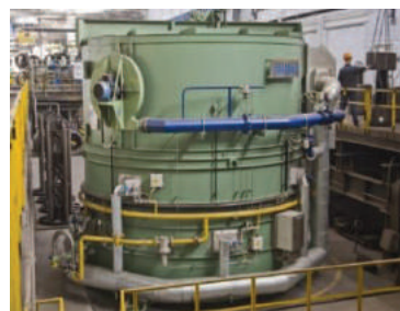
Рисунок 2. Колпаковая печь фирмы «EBNER»
