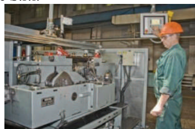
Рисунок 5. Однопозиционный двухударный автомат ND 90 фирмы WAFIOS
