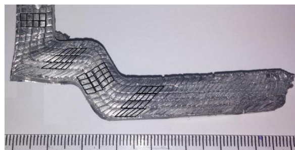
Рисунок 3. Параметры ячеек после Мульти-РКУП-Конформ
