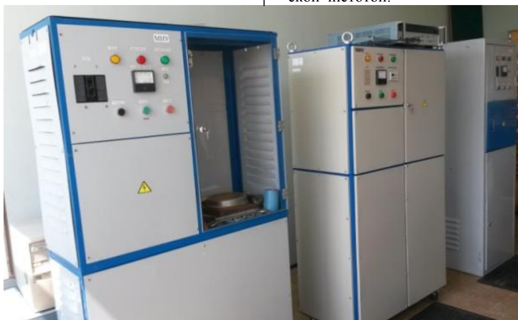
Рисунок 2. Оборудование, изготовленное в Физико-техническом институте НАН Беларуси для упрочняющей магнитно-импульсной обработки
