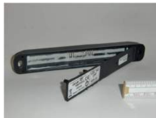
Рис. 1. RFID-метка, общий вид в открытом корпусе
