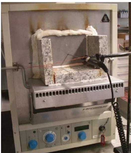
Abbildung 1 – Muffelofen Heraeus M 104 mit angepasstergipsbauplatte zur Ermittlung des Feuerwiderstands im Laborversuch
