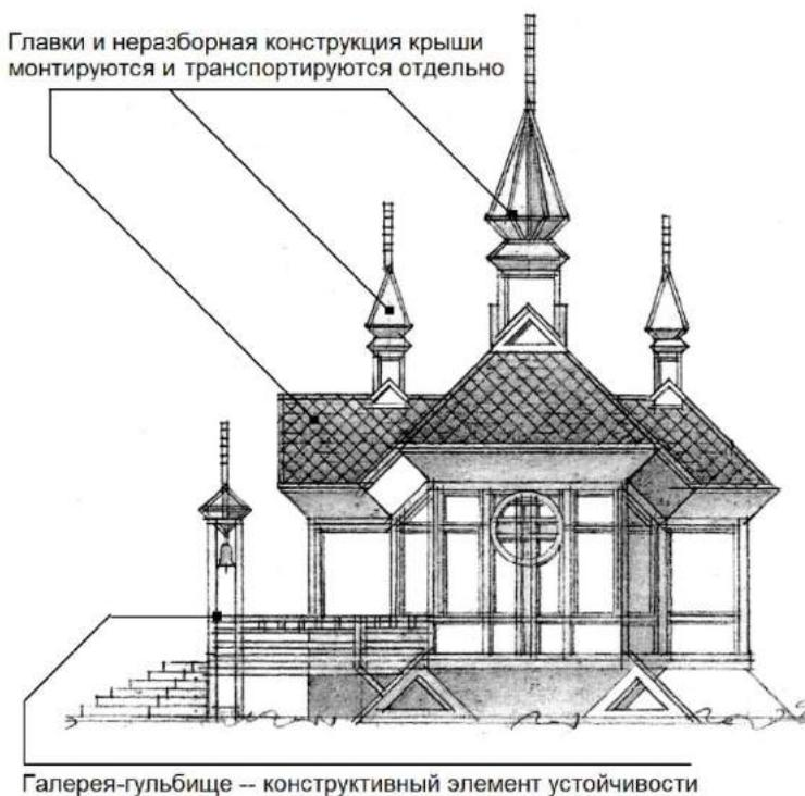
Рис. 2. Мобильный храм на авто-платформе (проект С.В. Борисова). Конструкция крыши с тремя главками демонтируется и транспортируется отдельно от основного объемного элемента храма. Гульбище со звонницей расположено в западной части храма
