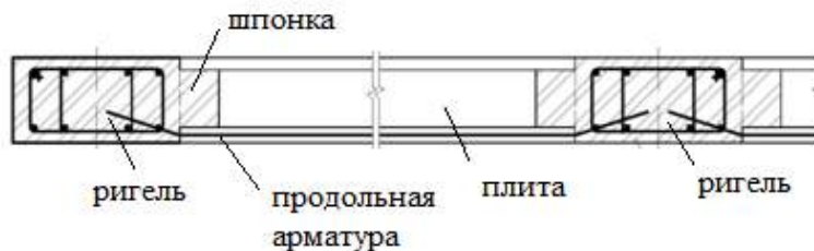
Рисунок 2. Конструкция сборно-монолитного каркаса многоэтажных зданий серии Б1.020.1-7
