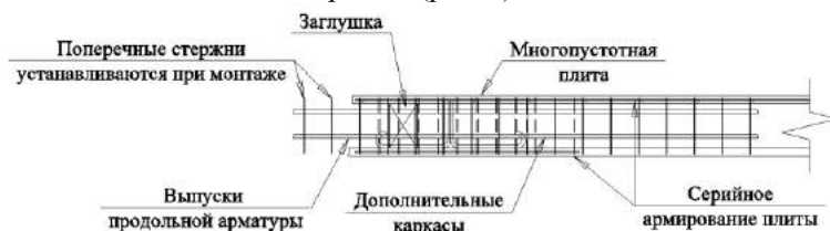
Рисунок 3. Многопустотная плита с установкой дополнительных каркасов
