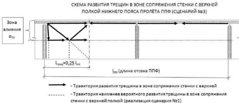
Рис. 2. Схема распространения трещины в отсеке подкраново-подстропильной фермы
