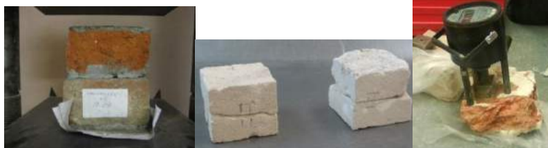
Рис. 3. Физико-механические испытания материалов кладки: 1 – испытание кирпича по прочности на сжатие; 2 – подготовка кладочного раствора к испытанию по прочности на сжатие; 3 – испытание на адгезию кирпича и кладочного раствора
