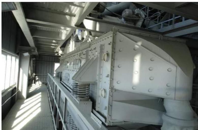
Рис. 2. Общий вид грохота с гасителями колебаний, расположенного на отметке + 12,660 м. цеха по производству гранул
