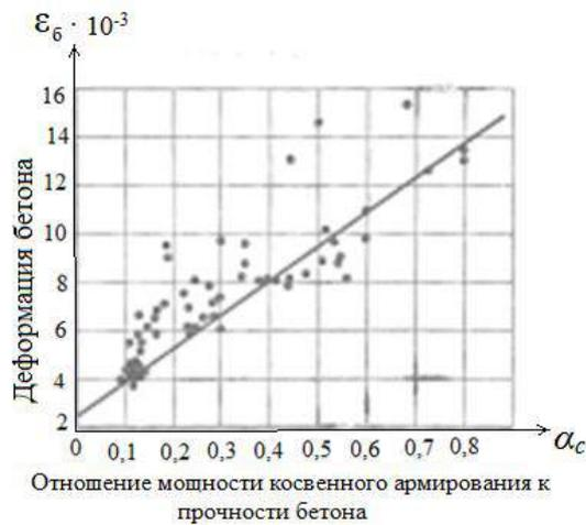
Рис. 2. Зависимость деформации бетона от величины  $\alpha_c$
