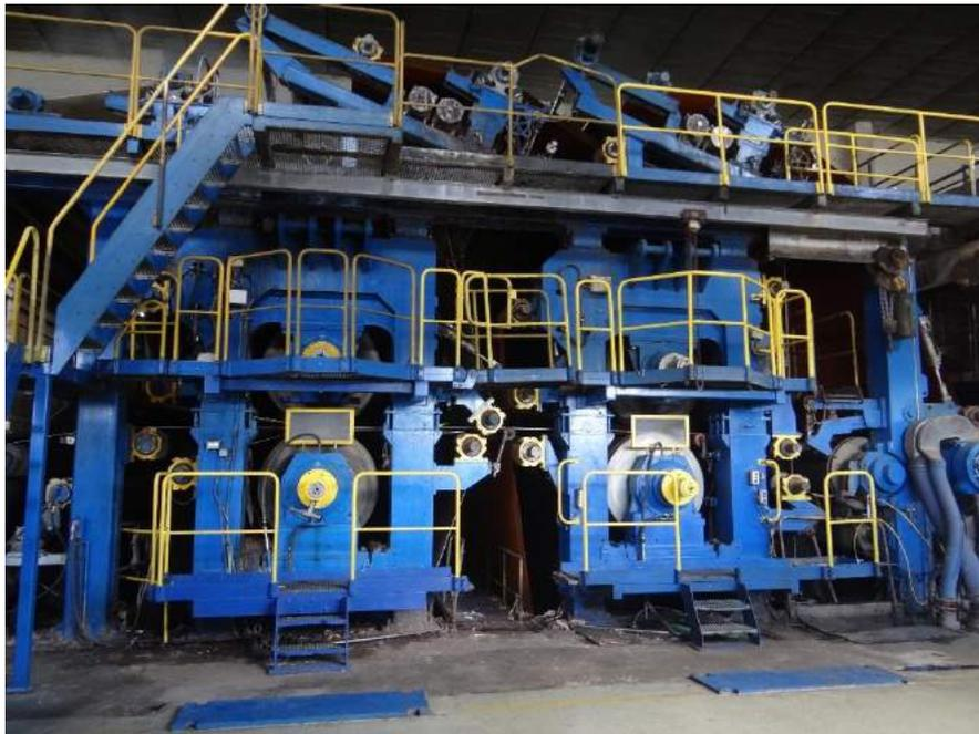
Рис. 8. Прессовая часть бумагоделательной машины
