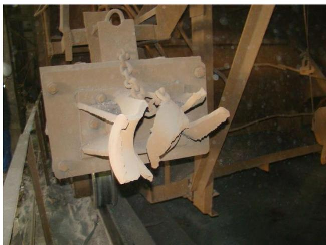
Рис.5. Разрушение упора мостового крана
