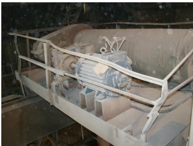
Рис. 8. Деформирование перильного ограждения тележки
