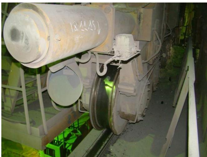
Рис. 4. Отсутствие сбрасывающей рамки и повреждение упругого элемента
