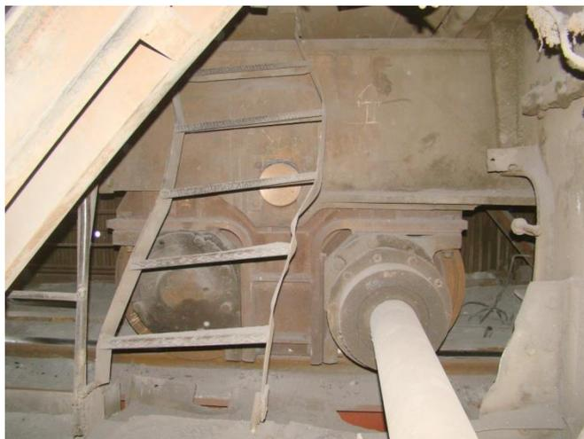
Рис. 9. Деформирование лестницы и отсутствие сбрасывающей рамки
