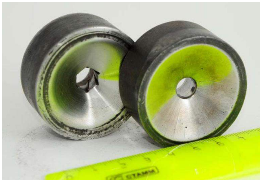
Рис. 2. Типы матриц, используемые при получении прутков
