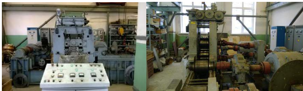
Рис. 1. Общий вид лабораторного стана-кварто и пульта управления
