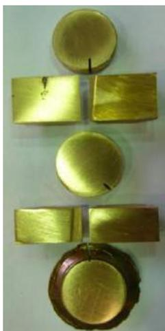
**Рис. 4. Деформированная заготовка, разрезанная на образцы**
