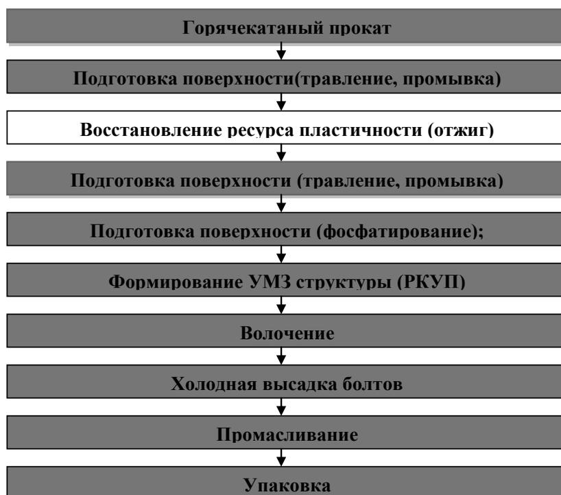
**Рис. 8. Адаптированный технологический процесс изготовления крепежа повышенного класса прочности из стали с УМЗ структурой**
