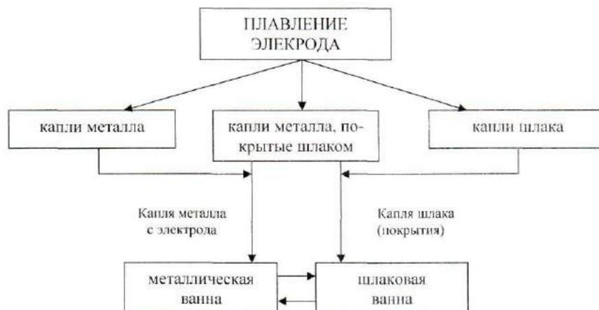
**Рис. 2. Блок-схема плавления электрода**
