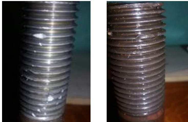
Рис. 3. Виды забоин на резьбе высокопрочных болтов
