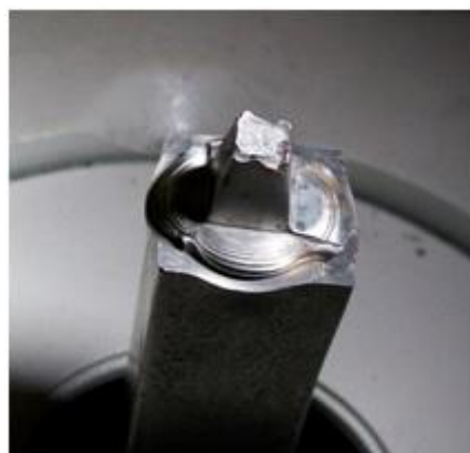
Рис. 8. Наплывы металла на границе рабочей части образца после нескольких циклов осадки
