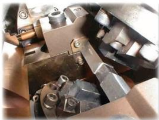
Рис. 7. Внешний вид камеры с образцом и бойками модуля MAXStrain
