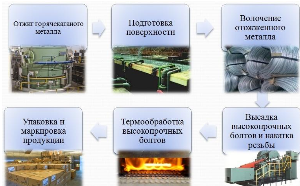
Рис. 4. Технологический процесс производства высокопрочного болта в условиях ОАО «ММК-МЕТИЗ»
