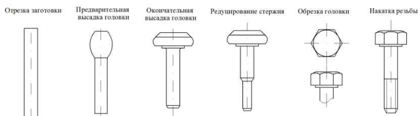
Рис. 1. Многопереходная технология изготовления болтов с шестигранной головкой
