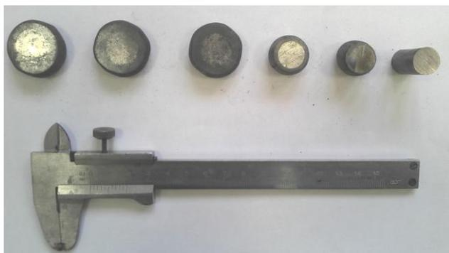
**Рис. 4. Осажённые с различной степенью деформации образцы**
