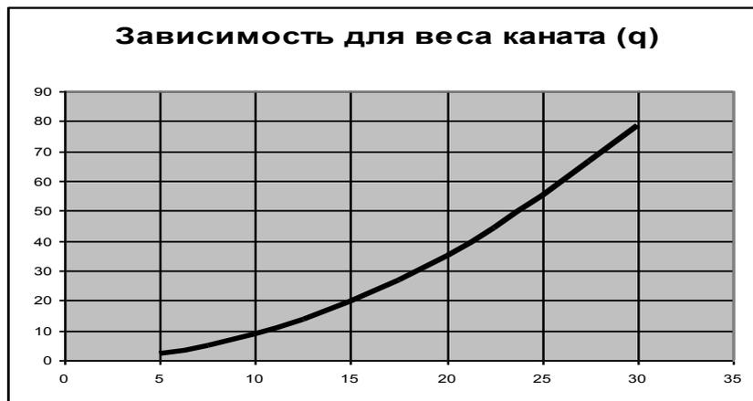
Рис. 2. Изменение веса каната (q) от его диаметра (Dк)
