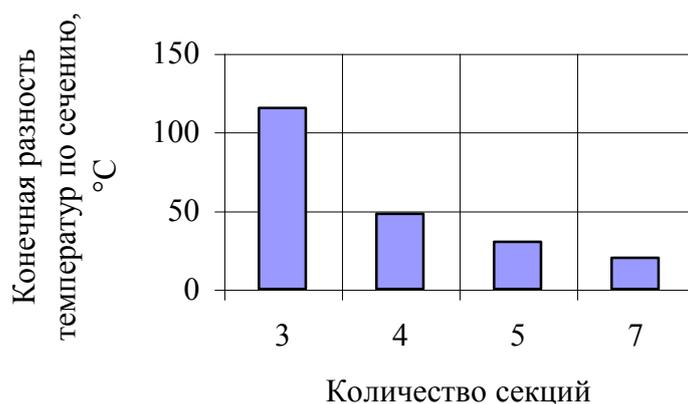
**Рис.1. Конечная разность температур по сечению катанки для линии с различным числом секций**
