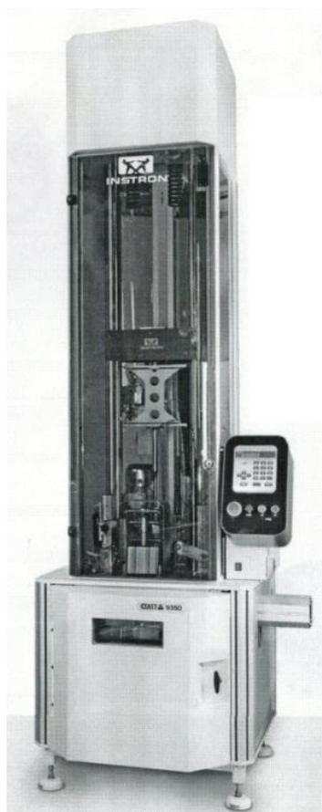
**Рис. 4. Общий вид устройства марки *CEAST9350***
