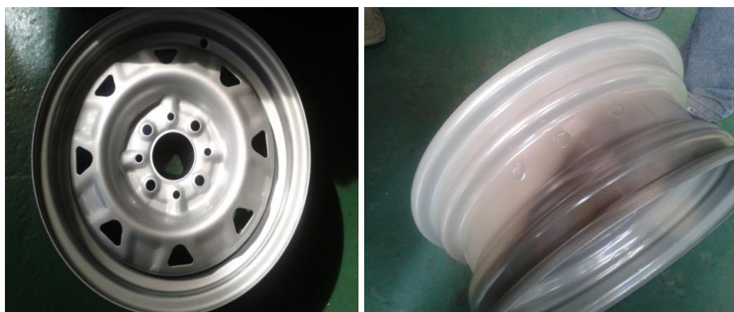
Рис. 2. Внешний вид опытной травленой дрессированной ленты из стали марки 07ГБЮ (а) и отштампованного из нее колеса для автомобилей семейства LADA ОАО «АВТОВАЗ» (б)
