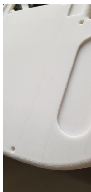
Рис. 2. Деталь, изготовленная методом селективного лазерного спекания, на установке Farsoon 403P
