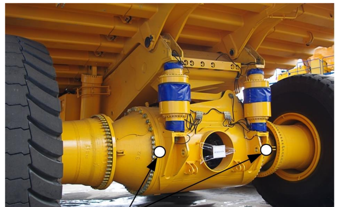
Места установки датчиков вибрации Рис. 2. Задний мост БелАЗа с обозначением мест установки датчиков вибрации
