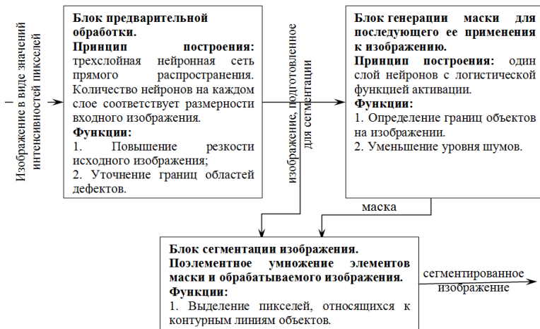
Рис. 4. Схема нейросетевой структуры для сегментации низкоконтрастного изображения
