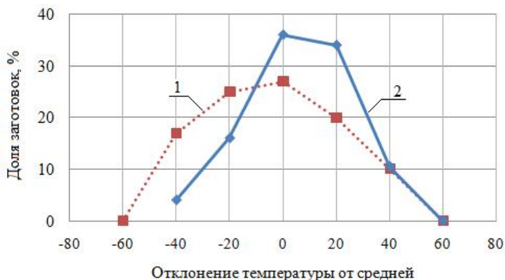
Рис. 5. Распределение отклонений t_{P3}(\tau) от общего среднего значения по печам: 1 – печи с САУ по t_{PII}(\tau) ; 2 – печь с САУ по t_{ПОВ}(\tau)
