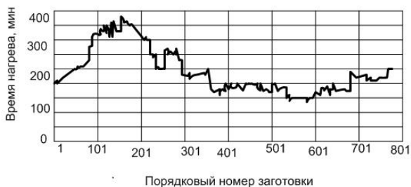
Рис.1. Изменение времени нагрева заготовок на стане 2000 ОА «ММК»
