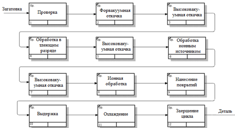
Рис.3. Динамическая модель процесса ионно-плазменного напыления детали (IDEF3)
